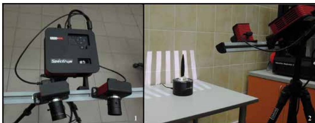
Рис. 1. Трехмерное моделирование при помощи сканера структурированного подсвета: 1 – сканер Range Vision Spectrum 3.1 в полной сборке; 2 – процесс сканирования каменного артефакта
